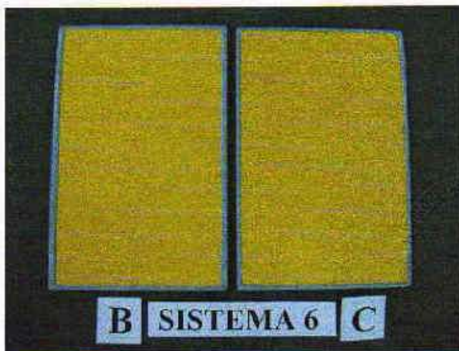
Fotografía 22.- SISTEMA 6, aspecto de las probetas B y C, después del ensayo de niebla salina.
