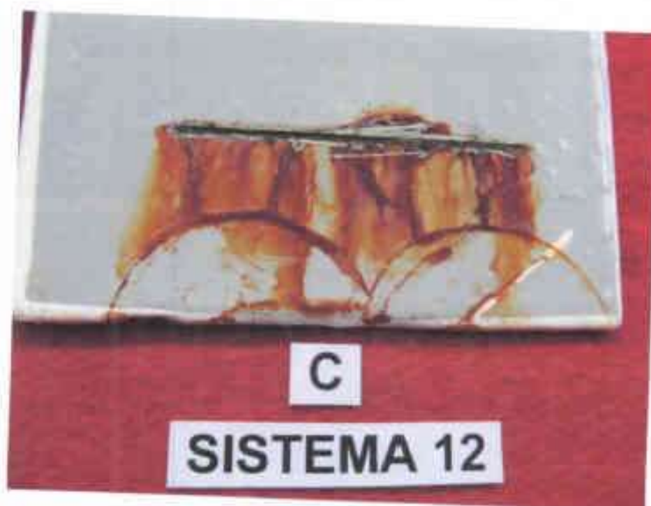
Fotografía 40.- SISTEMA 12, vista en detalle de la incisión en la probeta C, luego de 2016 horas de ensayo en cámara de niebla salina.
