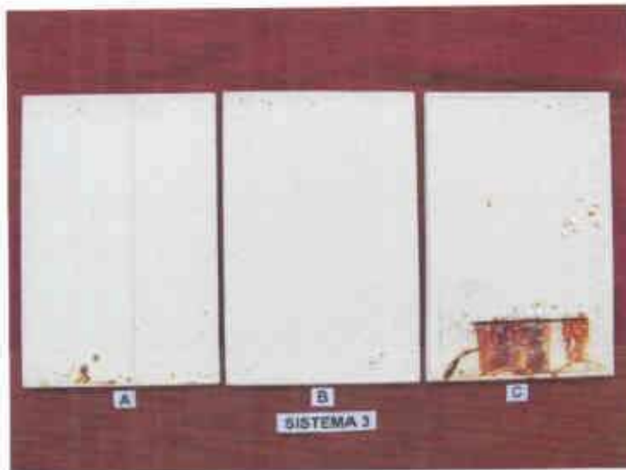
Fotografía 21.- SISTEMA 3, aspecto general de las probetas A, B y C, luego de 2016 horas de ensayo en cámara de niebla salina.
