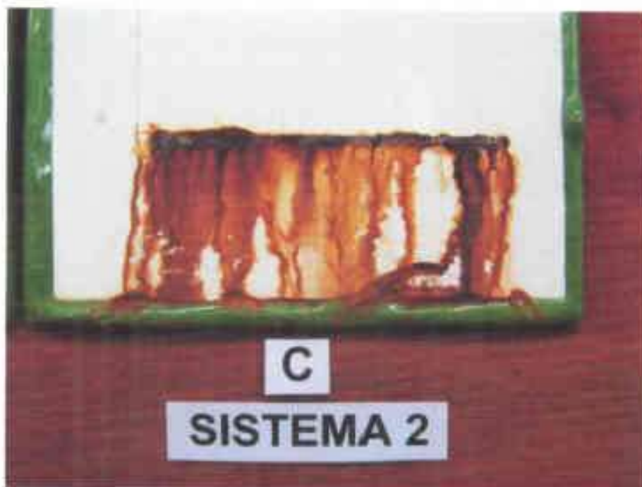
Fotografía 20.- SISTEMA 2, vista en detalle de la incisión en la probeta C, luego de 2016 horas de ensayo en cámara de niebla salina.
