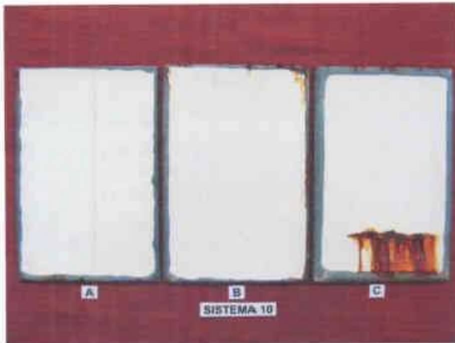
Fotografía 35.- SISTEMA 10, aspecto general de las probetas A, B y C, luego de 2016 horas de ensayo en cámara de niebla salina.
