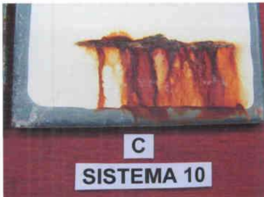
Fotografía 36 - SISTEMA 10, vista en detalle de la incisión en la probeta C, luego de 2016 horas de ensayo en cámara de niebla salina.
