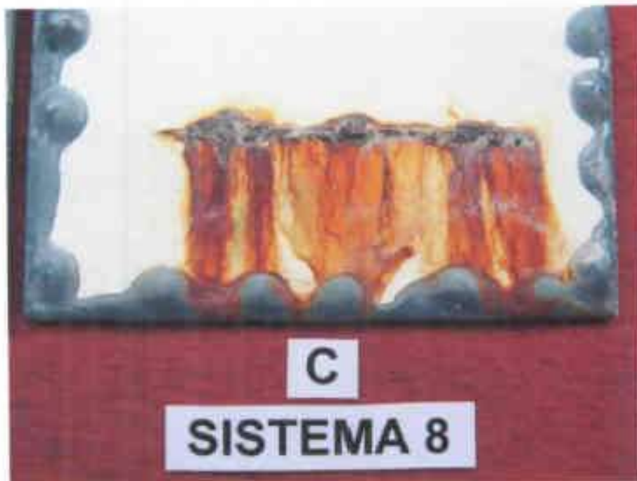
Fotografía 32.- SISTEMA 8, vista en detalle de la incisión en la probeta C, luego de 2016 horas de ensayo en cámara de niebla salina.
