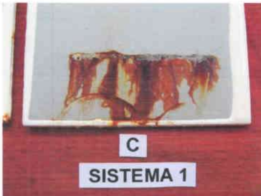
Fotografía 18.- SISTEMA 1, vista en detalle de la incisión en la probeta C, luego de 2016 horas de ensayo en cámara de niebla salina.
