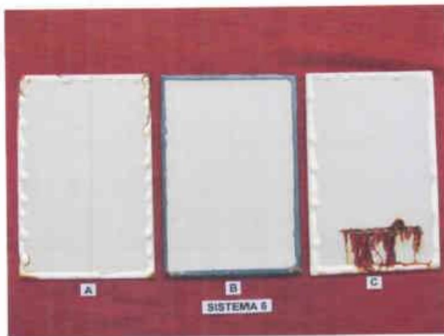
Fotografía 27.- SISTEMA 6, aspecto general de las probetas A, B y C, luego de 2016 horas de ensayo en cámara de niebla salina.
