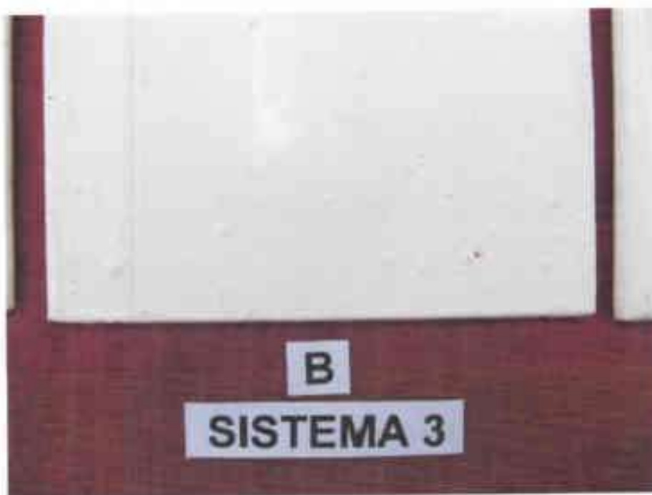
Fotografía 15.- SISTEMA 3, vista en detalle de la superficie de la probeta B, luego de 1008 horas de ensayo en cámara de niebla salina.
