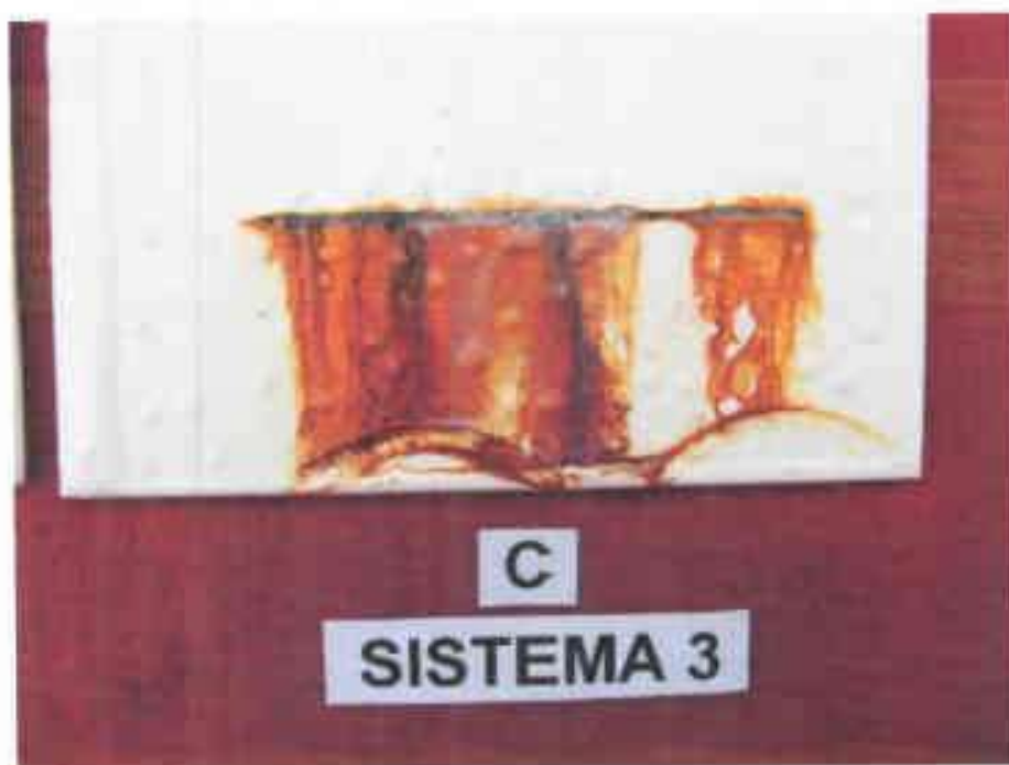
Fotografía 16.- SISTEMA 3, vista en detalle de la superficie de la probeta C, luego de 1008 horas de ensayo en cámara de niebla salina.
