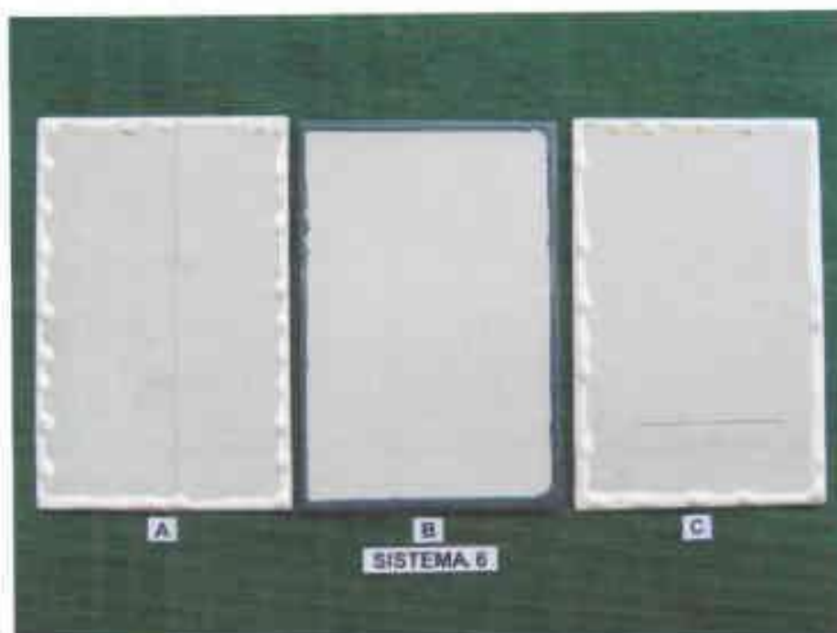
Fotografía 6.- SISTEMA 6, aspecto general de las probetas A, B y C, antes del ensayo de niebla salina.
