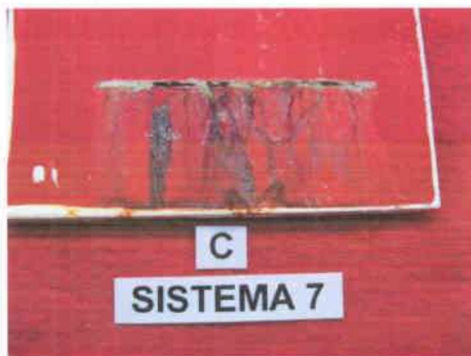
Fotografía 30.- SISTEMA 7, vista en detalle de la incisión en la probeta C, luego de 2016 horas de ensayo en cámara de niebla salina.
