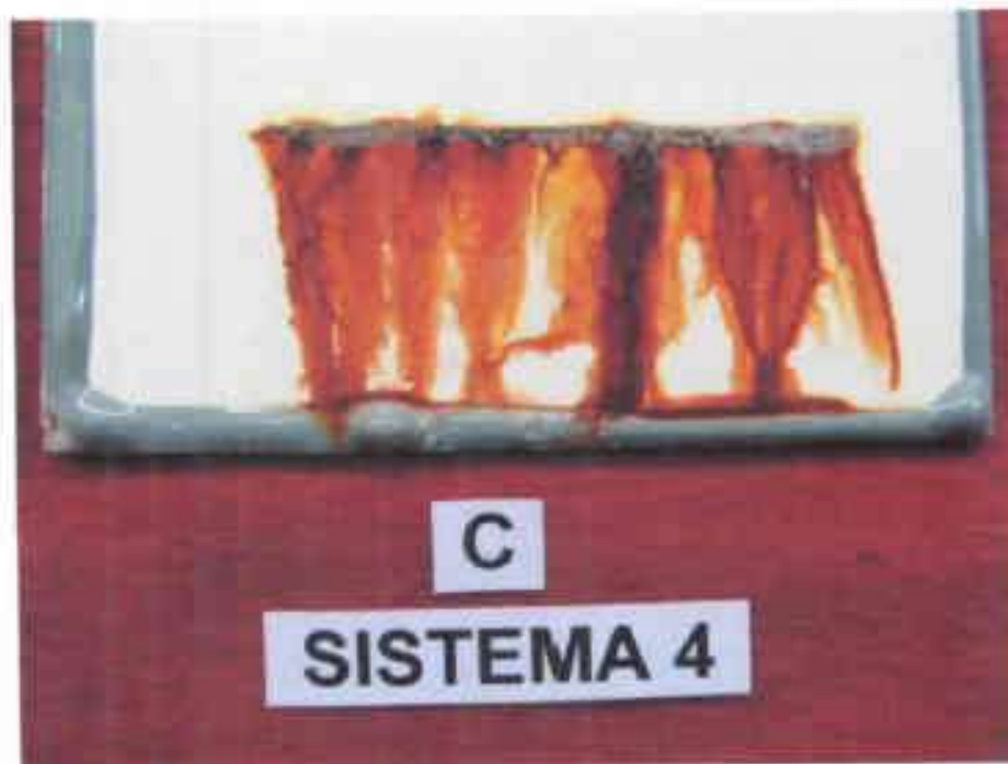
Fotografía 24.- SISTEMA 4, vista en detalle de la incisión en la probeta C, luego de 2016 horas de ensayo en cámara de niebla salina.
