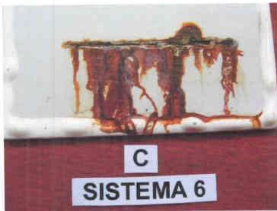
Fotografía 28.- SISTEMA 6, vista en detalle de la incisión en la probeta C, luego de 2016 horas de ensayo en cámara de niebla salina.
