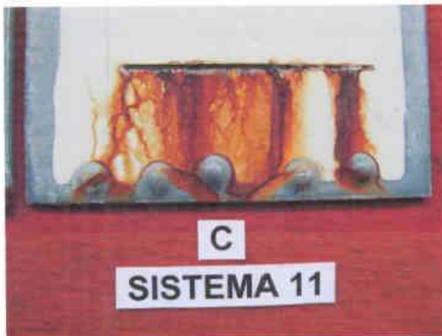
Fotografía 38.- SISTEMA 11, vista en detalle de la incisión en la probeta C, luego de 2016 horas de ensayo en cámara de niebla salina.
