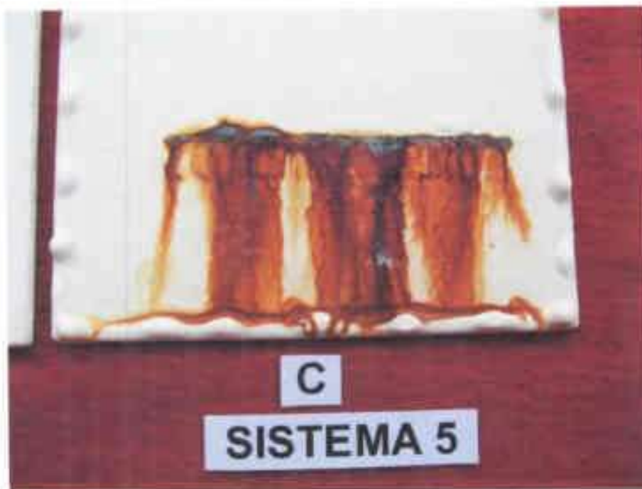
Fotografía 26.- SISTEMA 5, vista en detalle de la incisión en la probeta C, luego de 2016 horas de ensayo en cámara de niebla salina.
