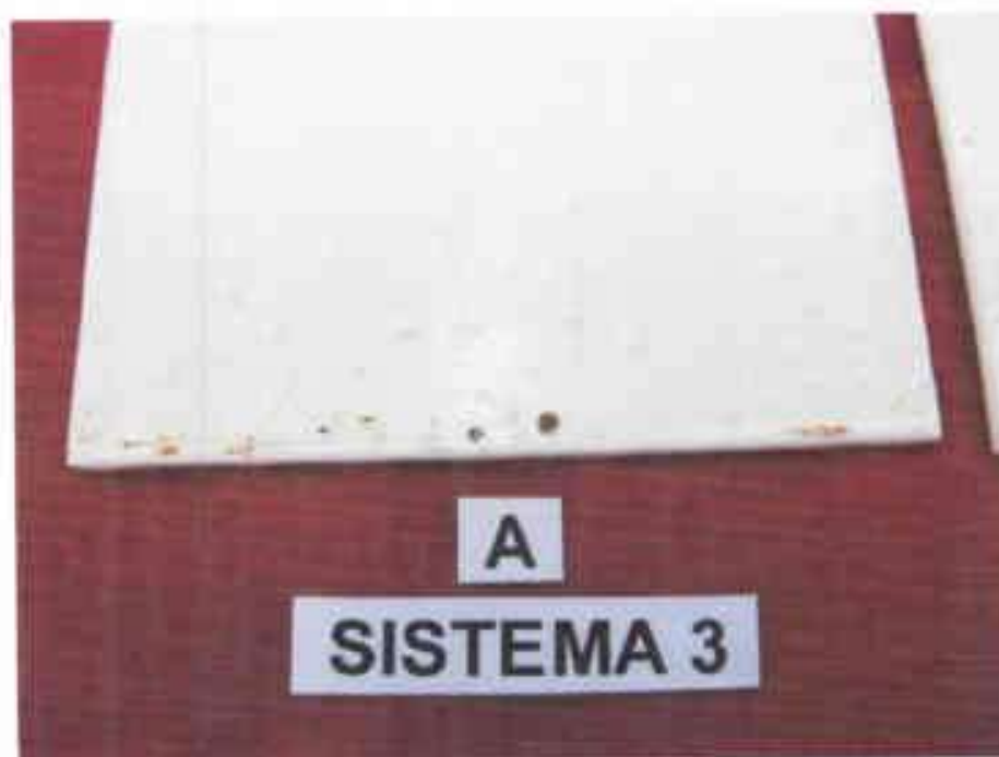
Fotografía 14.- SISTEMA 3, vista en detalle de la superficie de la probeta A, luego de 1008 horas de ensayo en cámara de niebla salina.
