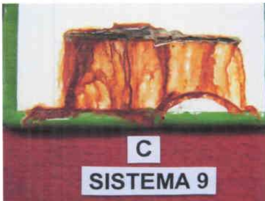
Fotografía 34.- SISTEMA 9, vista en detalle de la incisión en la probeta C, luego de 2016 horas de ensayo en cámara de niebla salina.
